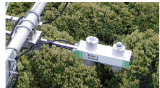
上向きと下向きに センサーを2つ設置
