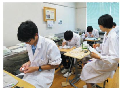
精密天秤室での分析試料の秤量作業
