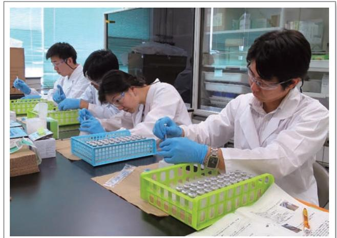
▲3日目 水酸化ナトリウムを添加して、脱窒菌の反応を停止させる
