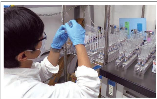
▲2日目 脱窒菌の入った培地入りのバイアル内を嫌氣的にするために $N_2$ ガスで置き換える
