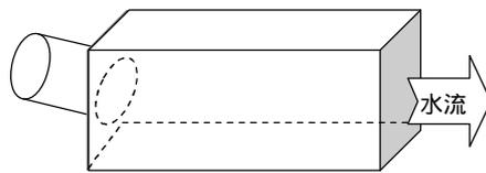
自由に流量を変化させ、その都度流速を測れる装置を、ゴムホース、ペットボトルなどを用いて簡単に作成した。採集してきた昆虫ごとに装置の上に置いて流速を少しずつ増していき、水に流された
