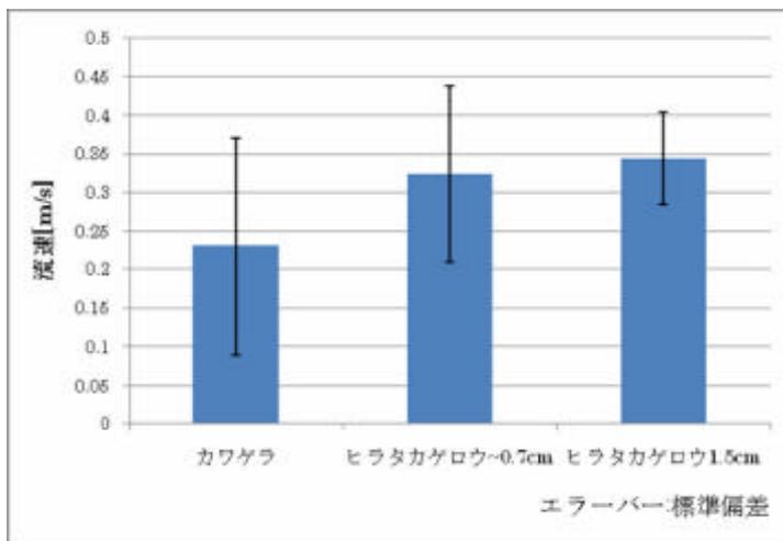
実験の結果、カワゲラは平均 0.23[m/s]の流速まで耐えたのに対し、ヒラタカゲロウは大ききによらず 0.33[m/s]前後の値となった。装置の底は藻類のあまり生えていない平たい石を置き、その上に昆虫を放して実験した。大きい流速でも耐えられると思われたヒラタカゲロウと、逆に、流体の抵抗を大きく受けると予想されるカワゲラを比べても、明確な違いは生まれなかった。
