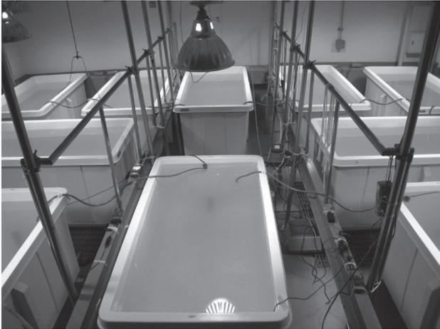
図6. 実験に用いたメソコスム。容量 2000L (1 × 2 × 1 m)、明暗周期 14:10h、水温は 20℃ に設定。実験開始前までタンク間をホースでつないで水を流し、水質を均一にしている。
