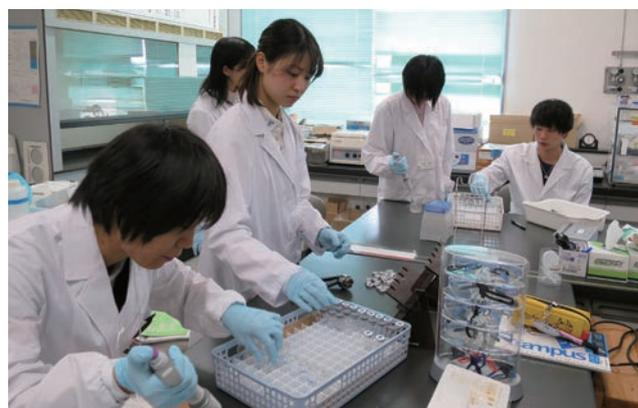
▲2日目 脱窒菌の入った培地を20mlバイアルに分注してプチルゴム栓、アルミキャップで蓋をする。
