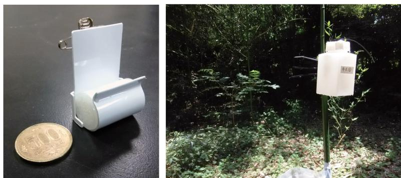
▲図1 本研究で用いられた $\text{NH}_3$ の拡散型パッシブサンプラー(左)、及び現場での設置状況(右)
