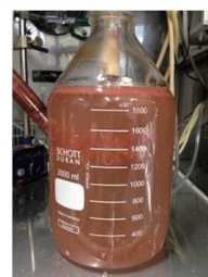
▲図1. 海洋性アナモックス細菌 Ca. Scalindua sp. の膜分離型連続培養培養リアクター。アナモックス細菌は、細胞内に鉄を含有するヘムタンパク質を多く含むため鮮やかな赤色に見える。
