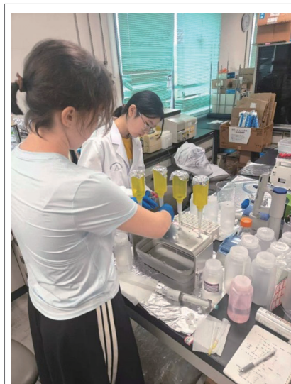
▲図1 硝酸イオンの濃縮実験
